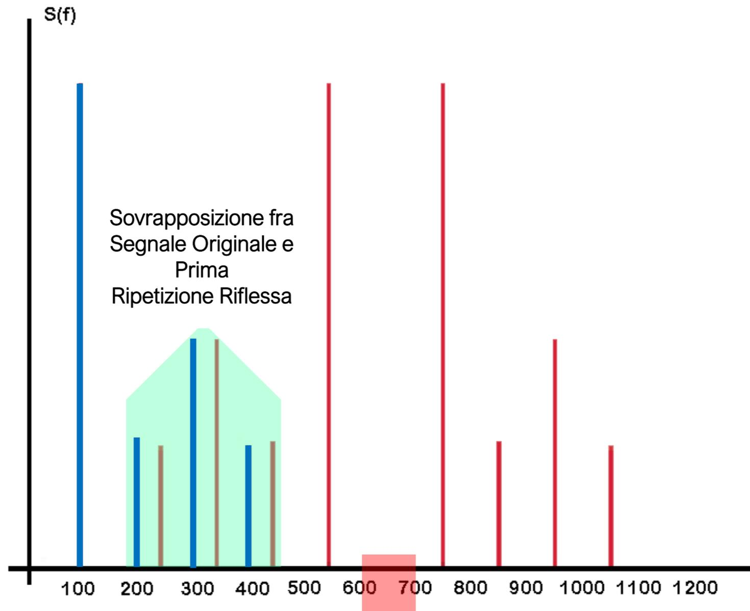
Nell'esempio il segnale è stato campionato ad un frequenza di 650 Hz, più piccola di quella suggerita dal teorema del campionamento. Alcune righe spettrali attorno alla frequenza di campionamento, sono andate a sovrapporsi alle frequenze originali.
