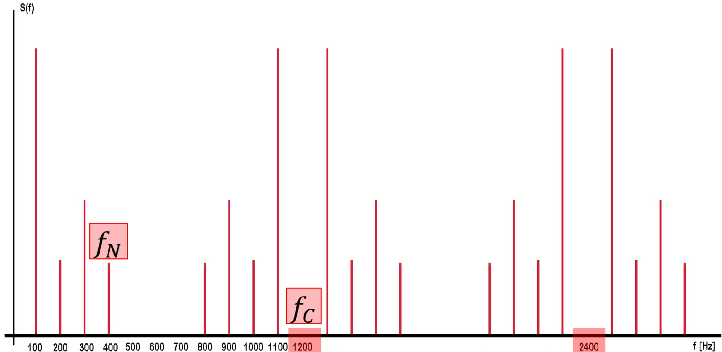
Nello spettro del segnale campionato, lo spettro originale si ripete per multipli della frequenza di campionamento e viene anche riflesso. Nell'esempio si vede lo spettro del segnale campionato con tasso di campionamento pari a 1200 Hz.
