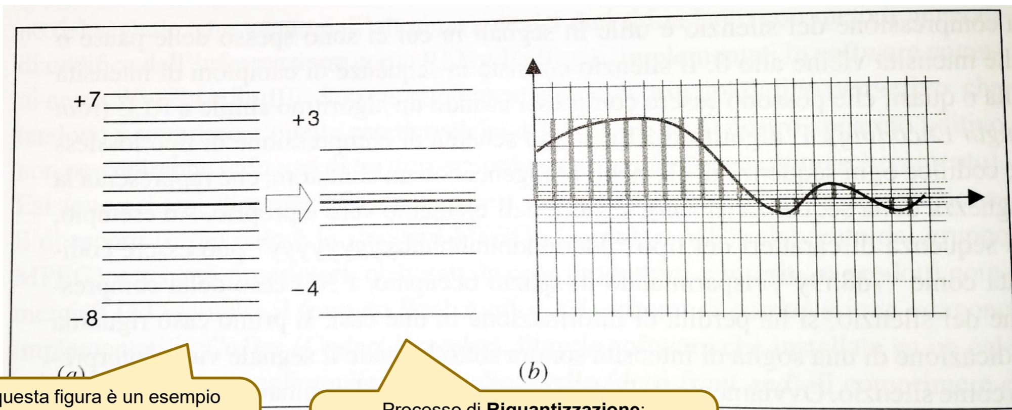
Nota Bene: questa figura è un esempio schematico del passaggio da una quantizzazione uniforme ad una non uniforme. Anziché passare da 16 bit a 8, in questa figura passiamo solo da 4 a 3
